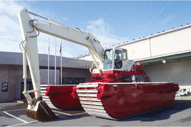
泥上車 PON125 超軟弱地盤用混合機・掘削機
