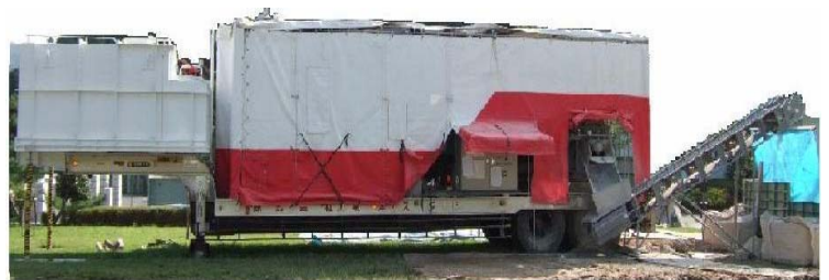
写真-1 湿潤セメント製造装置外観
